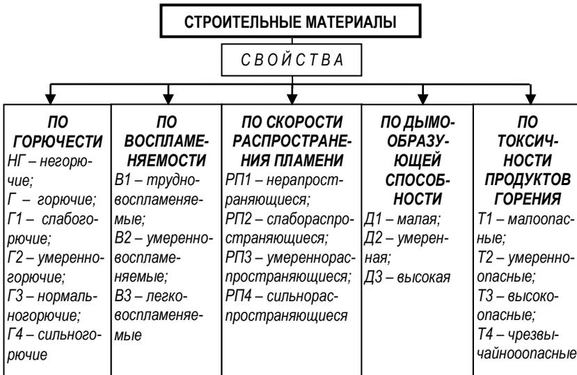
Рис. 4. Классификация строительных материалов по пожарной опасности
